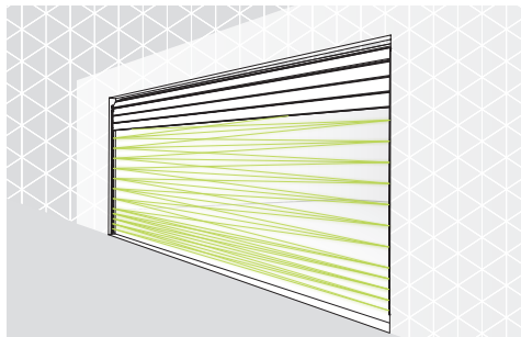
Figure 3: Portes sectionnelles avec effacement des faisceaux
